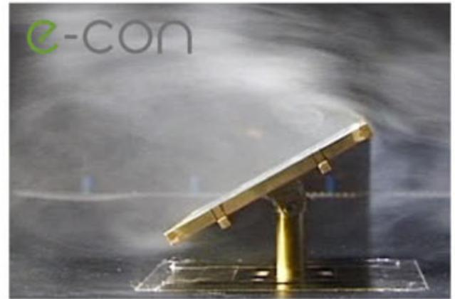
In Abhängigkeit der Anströmrichtung und dem Neigungswinkel der Unterkonstruktion resultieren die horizontalen und vertikalen Einwirkungen für die Auflastberechnung.
